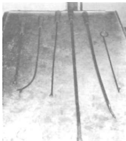
Ganxos de Farcir. Vares de ferro que s'utilitzen per a introduir la palla o llana a l'interior de la collera. Els ganxets petits s'empren per al buidat de les colleres o per extreure la llana sobrant. Les seues característiques presenten els ganxos amb figura recta o corba en funció de la seua utilització.
